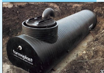
Per un corretto interramento prevedere un perimetro intorno al serbatoio di 500 mm riempito di sabbia
